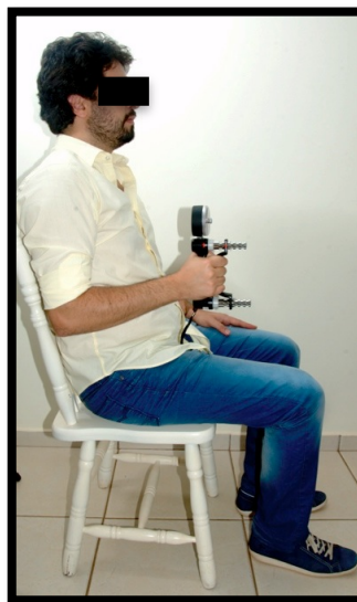
Figura 9. Dinamômetro hidráulico (Jamar®) Figura 10 – Posicionamento segundo à SBTM
