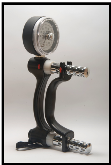
Figura 9. Dinamômetro hidráulico (Jamar®) Figura 10 – Posicionamento segundo à SBTM
